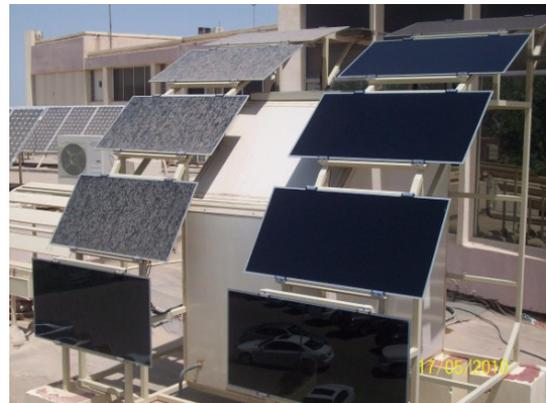
**Figure 1:** Photovoltaic module test stand
